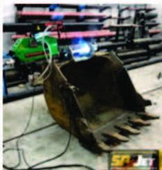
Также мы оказываем услуги по восстановлению отверстий диаметром от 42 до 400 мм (предварительная расточка эллипсных отверстий с последующим наплавлением и окончательной расточкой наплавленного слоя до требуемого размера с заданной точностью до 0,05мм).
