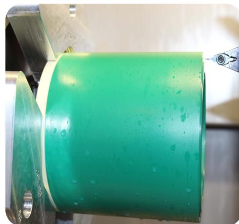
В Европе данный метод изготовления уплотнений уже давно заменил метод формования. Время изготовления в течение 1 часа. ТОО "SP JET" – фирма, называемая "завод одного часа". Максимальный размер уплотнения до 600 мм. Точность изделия до 0,01 мм.
