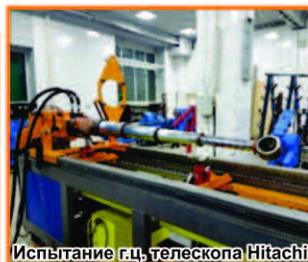
Испытание г.ц. телескопа Hitachi
